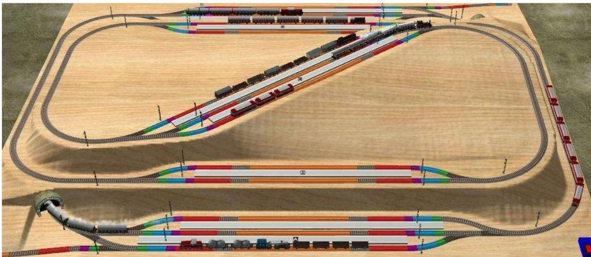
Die diesem Abschnitt zugrunde gelegte Anlage besitzt zwar denselben Gleisplan wie die Beispiel-Anlage aus dem vorangegangenen Abschnitt. Sie besitzt aber eine wesentlich flexiblere (und damit aber auch aufwendigere) Automatik-Steuerung. Hier können nun alle Bahnhofsgleise in beiden Richtungen befahren und durch den jeweils ankommenden Zug je nach Verfügbarkeit dynamisch ausgewählt werden.
