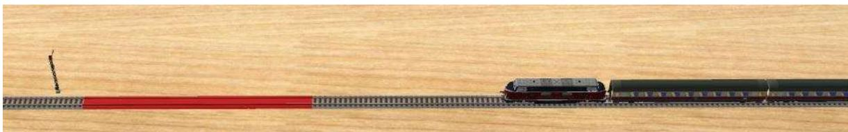
Minimal-Konfiguration, mit der eine Signalschaltung mit Zugbeeinflussung realisiert werden kann. Der Zug wird – durch das Signal gesteuert – angehalten und gestartet.
