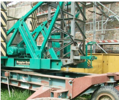
Die **Turmverbindung** nach dem Aufstellen des Turms mit der **Drehbühne**, wird mittels Schrauben oder Bolzenverbindungen ausgeführt. Foto Zsolt Czimbuli
