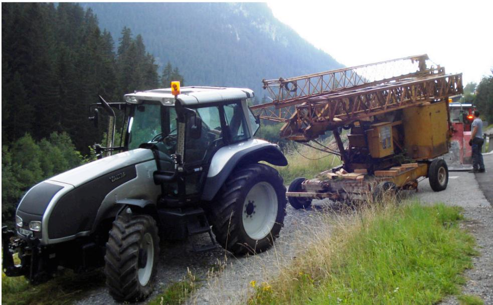
Sehr kompakter Transport des Potain R 207 P.R. mit nur 7.5 m Länge. Das **Zusatzturmstück** kann ebenfalls mit dem Kran mittransportiert werden. Dieses Konzept konnte in den sechziger Jahren als revolutionär bezeichnet werden.
