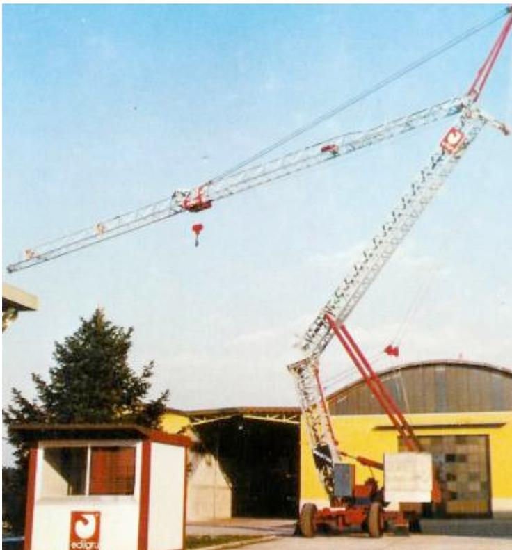
*Edilgru* Schnellmontagekran mit **hydraulischer Montage**. An Stelle der **Aufstellseile** und einer **Montagewinde** kommt ein- oder mehrere **Hydraulikzylinder** zur Anwendung. Die Italienischen Hersteller gelten als Pioniere der hydraulischen Kranmontage. Die Auslegerspitze muss manuell geklappt werden und verfügt noch über keine automatische Montage.
