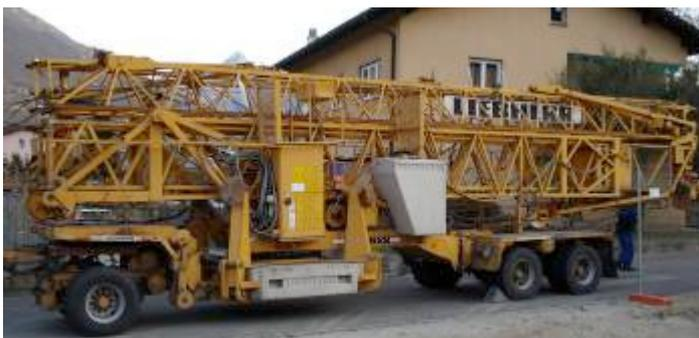
*Strassentransport als Anhänger mit luftgefederter Schnellläuferachse mit max. 80 km/h Transportgeschwindigkeit.* Die Hinterachse kann zur besseren Manövrierbarkeit gelenkt werden.
