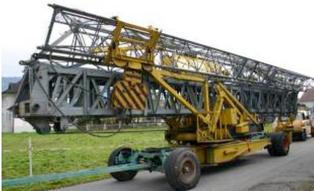
*Strassenfahrwerk mit Achsschenkellenkung an einem Huggler Kran.* Nachteilig sind der begrenzte Lenkeinschlag und die dadurch reduzierte Manövrierfähigkeit.
