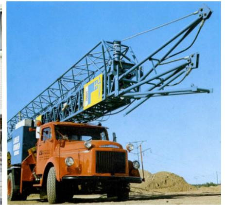
Als Weiterentwicklung der **hochmobilen Schnellmontagekrane**, können die **Mobilkrane** von **Munsters, Spierings, Liebherr** und **Anderen** bezeichnet werden. Diese Geräte vereinigen einen **Unterwagen** aus dem **Mobilkranbau** mit einem aufgebauten modifizierten **Schnelleinsatzkran**. Schon in den sechziger Jahren wurden Schnellmontagekrane auf LKW Chassis aufgebaut, um schnell von einem Einsatzort zum Andern zu gelangen. Rechts im Bild ein Linden SMK aufgebaut auf einem Volvo LKW Chassis.
