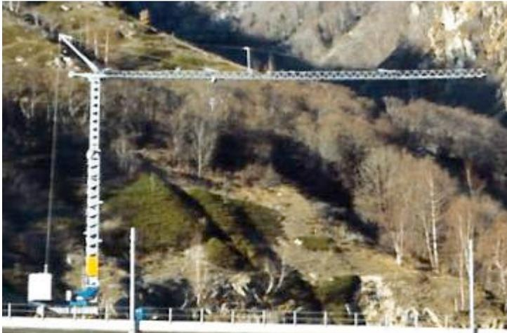
1979/ 1980 bringt das Schweizer Unternehmen *Conducta* die **Vollwandbauweise** bei den Krantürmen auf den Markt. Die grösseren Typen werden mit Polygonelementen ausgerüstet. Durch die Vollwandbauweise mit teleskopierbarem Turm lässt sich vor allem die Transporthöhe beträchtlich reduzieren.
