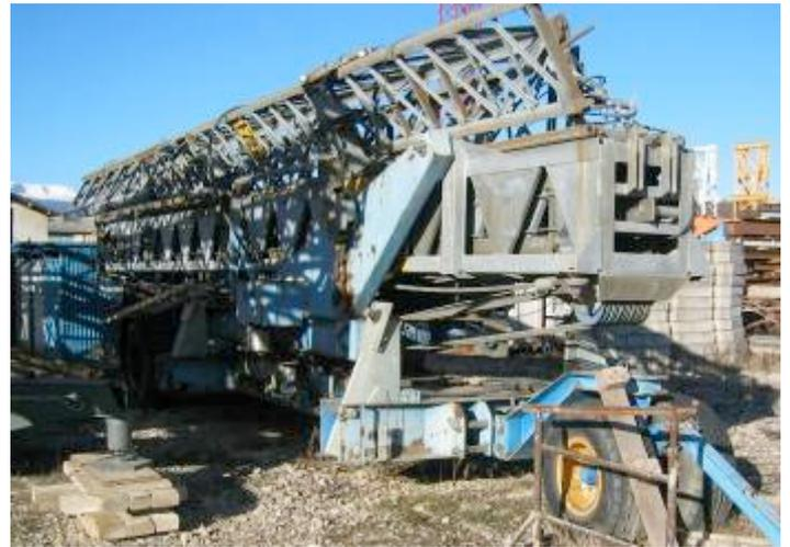
Detail eines *Conducta* Kranturms mit **Polygonelementen** im Transportzustand. Der Ausleger wird zusätzlich zum Erreichen einer günstigen Transporthöhe seitlich geklappt. Der Kranturm wird mit einer **Montagewinde** und einer vielfachen **Seileinscherung** aufgerichtet. Die **Teleskopierung** erfolgt ebenfalls mit Seilen.
