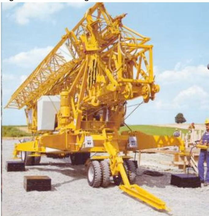
**Abspindeln** an einem Liebherr Schnellmontagekran mittels Hilfsseilen und Wippbewegung der Vorderachse. Der Kran kann so ohne fremde Hilfsmittel abgespindelt werden. Als **Fundamente** auf festem Boden dienen **Hartholzschwellen** oder **vorfabrizierte Betonelemente**. Die Grösse beträgt in der Regel ca. 1 x 1 m und muss je nach Typ und **Bodenbeschaffenheit** gewählt werden.
