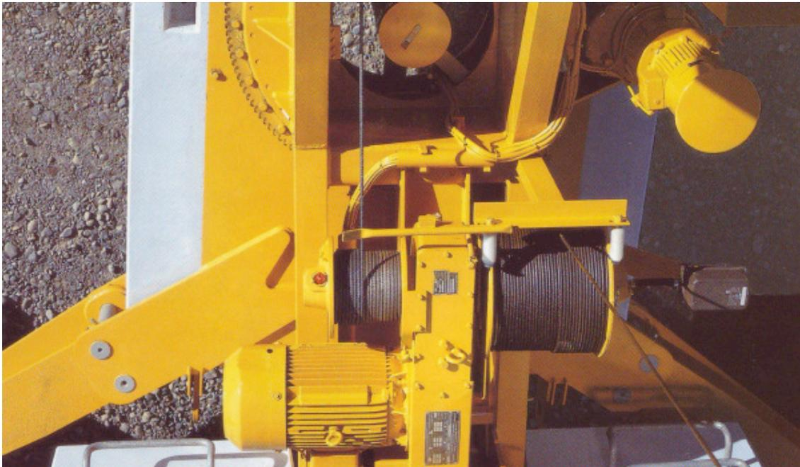
Über die **Montagetrommel** (links im Bild) wird sowohl der Turm aufgestellt, wie auch der Turm ausgefahren, falls der Kran mit **Teleskopturm** ausgestattet ist. Die **Montagewinde** wird meistens, wie hier im Bild, vom **Hubmotor** angetrieben. Dazu lässt sich das Getriebe umschalten oder ist mit einem **Differenzialantrieb** ausgerüstet, eine Trommel braucht dann jeweils blockiert zu werden. Der **Hubendschalter** sitzt auf der verlängerten Welle der Hubtrommel (rechts im Bild).
