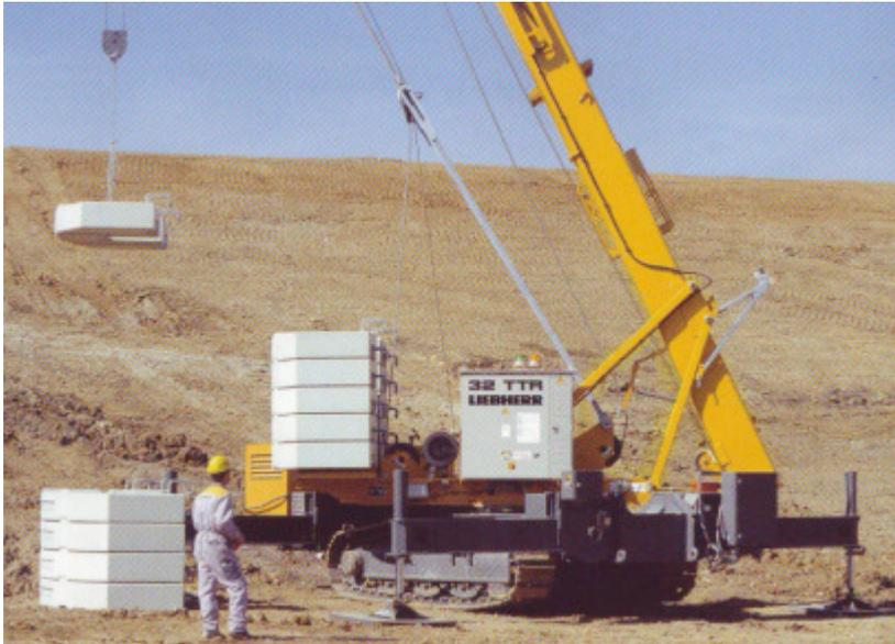
Auflegen des Ballastes mit der Hubwinde und **Wippbewegung** des Turms an einem Liebherr TTR Kran. Die **Ballastplatten** werden automatisch zentriert und sind dank der halbautomatischen **Ballastierschere** ist eine Einmannmontage möglich.
