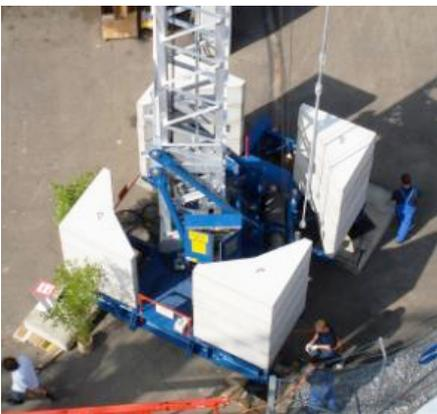
**Pekazett Schnellmontagekran mit Gegenausleger**. Diese Bauart hat keine drehenden Ballastteile in Bodennähe und der **Platzbedarf** am Boden ist sehr gering. Zum Transport wird der **Gegenausleger** mit dem **Gegengewicht** an den Turm angeklappt. Das neuste Modell dieses Herstellers hat 45 m Ausladung und kann mit voll ausgestossenem Mast eine beachtliche Hakenhöhe von 36 m erreichen. Das mittlere Kulissenmaststück wird mit dem eigenen Haken positioniert.
