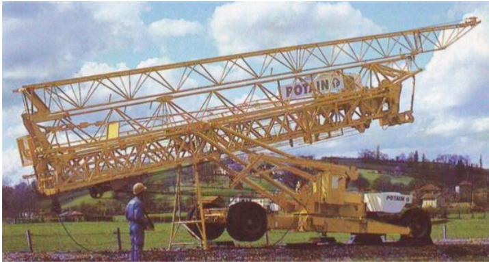
**Abspindeln oder Abbocken** des Krans mit Hilfe eines zusätzlichen Bocks unter zu Hilfenahme der Turmmontagebewegung. Der Turm ist über **Parallelenker** mit dem Oberwagen verbunden. Durch diese **Kinematik** wird erreicht, dass sich der Schwerpunkt des Krans bei der Montage nicht ungünstig
