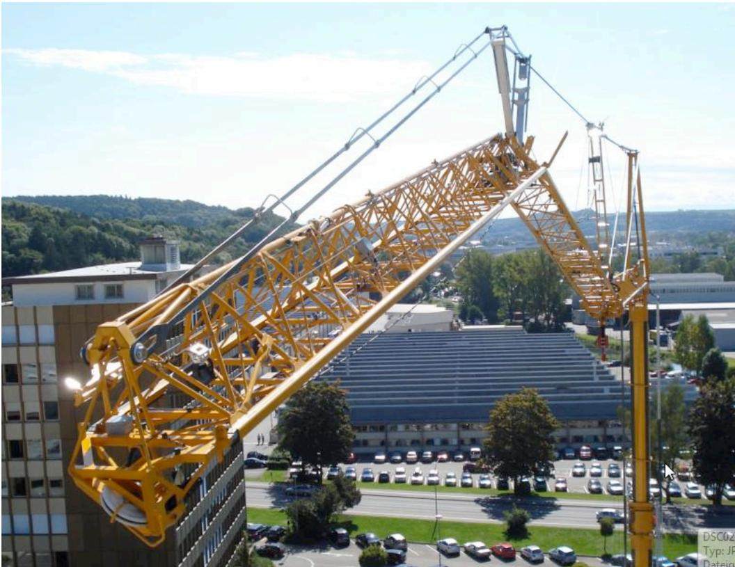
**Auslegerluftmontage** in grosser Höhe an einem *MK 110 Faltkran*. Störende Hindernisse wie Stromleitungen stören so bei der Montage nicht mehr. Die Montage erfolgt weitgehend automatisch und braucht vom Kranführer nur überwacht zu werden. Das Auslegervorderteil wird teleskopiert.
