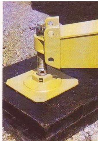
*Schienenfahrbare- und stationäre Ausführung mit **Abstützspindeln** und **Abstützplatten** an den **Spreizholmen** eines Potain GMR Krans. Die **Schienenfahrwerke** können leicht an- oder abgebolzt werden und sind austauschbar.*
