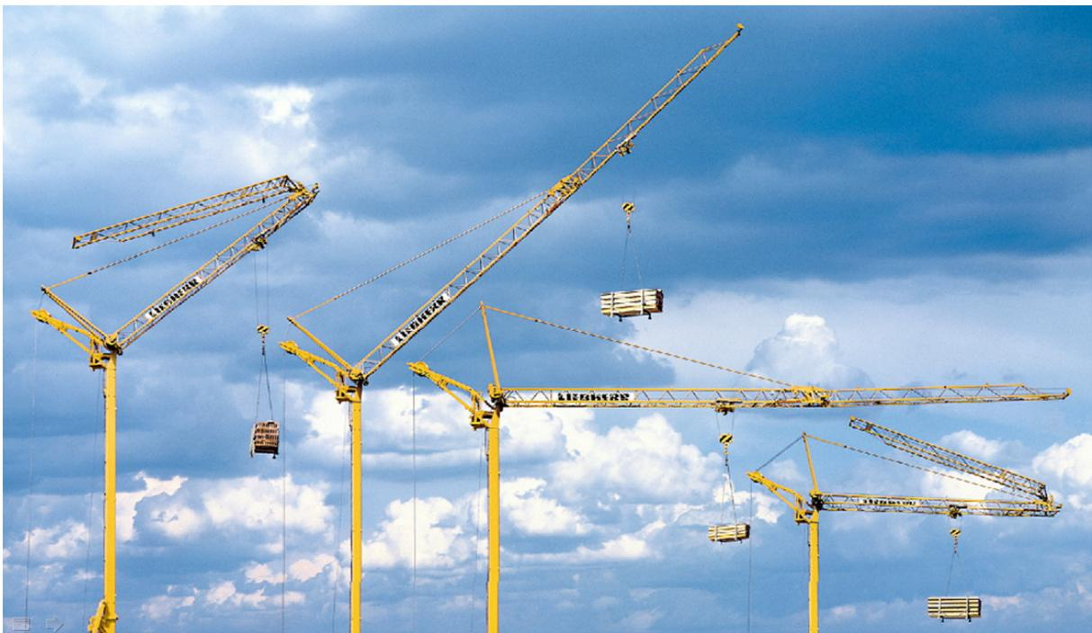
Stufenlose Verstellbarkeit des Auslegers bis **45° Steilstellung** bei entsprechend reduzierter Traglast an einem Liebherr SE Kran. Zusätzlich kann das **Auslegervorderteil** hydraulisch geklappt werden, um Hindernissen auszuweichen.
