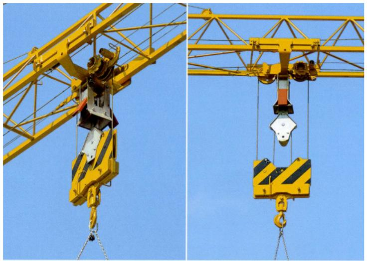
Manuelles **Umschieren** durch Steckbolzen links und halbautomatisch durch **Umschierautomatik** rechts.
