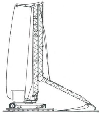
Durch das Ausfahren des **Innenturms** wird beim Potain GMR Kran der Ausleger gestreckt und dann aufgezogen. Moderne Krane verfügen über **Auslegerluftmontagen**, dabei berührt die Auslegerspitze den Boden nie.
