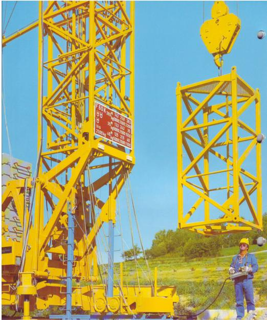
Durch nachträgliches **Einklettern** von **Turmstücken** kann bei manchen Schnellmontagekranen die **Hakenhöhe** bis gegen 35 m erhöht werden. Die Firma Reich hat als Erste dieses fortschrittliche System in den siebziger Jahren eingeführt.
