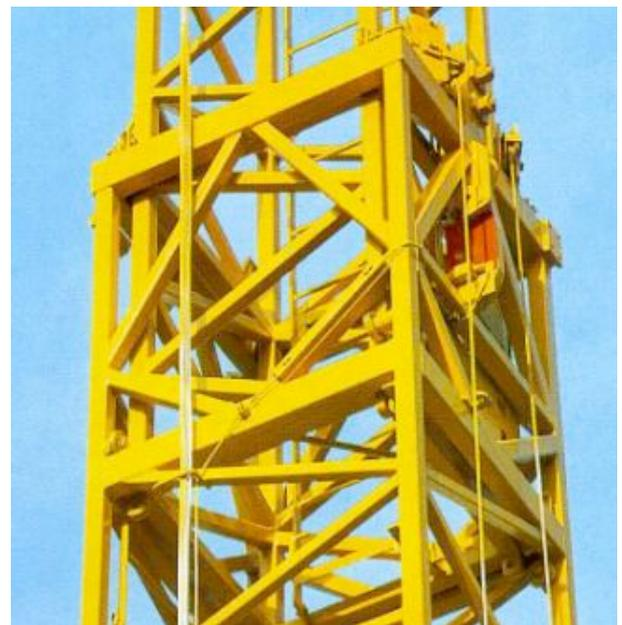
Die **Turmverriegelung** des ausgefahrenen Innenturms wird über Bolzen, Haken, Klinken oder Schrauben ausgeführt. Links im Bild die Turmverriegelung an einem MM Kran, welcher über automatisch einrastende Bolzen verfügt. Rechts der automatisch einfallende Haken an der Liebherr Turmverriegelung (rot lackiert).
